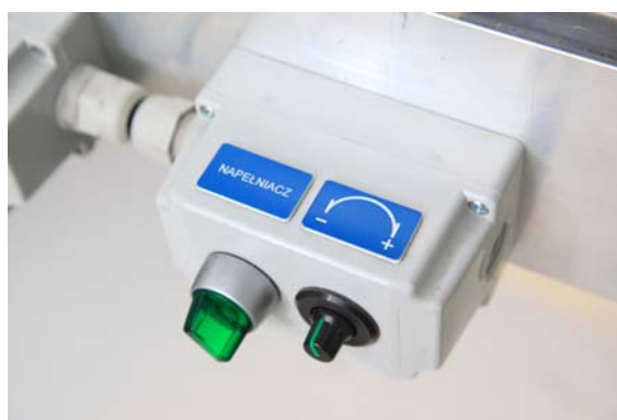
Kaseta sterownicza urządzenia napełniającego
