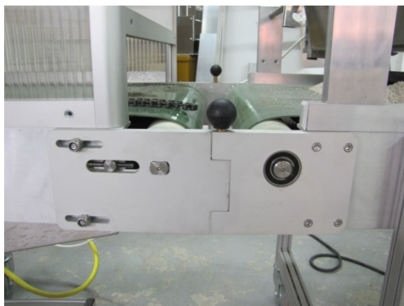
Płytki montażowe z naciągami oraz płytki montażowe wałki biernego. Widoczne gałki rygli zamka.
