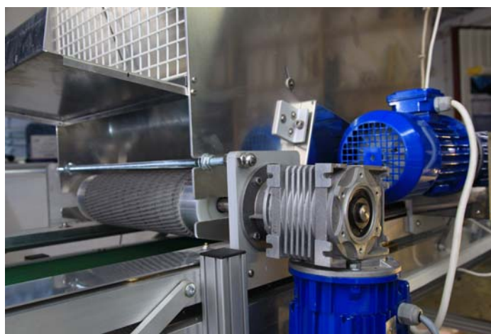
Wałek dociskowy tac pod urządzeniem napełniającym. Powyżej wałka widoczna ruchoma osłona wałka dociskowego.
