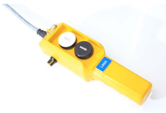
Pilot uruchamiający wszystkie urządzenia z boku widoczny potencjometr regulujący prędkość pasa transportującego
