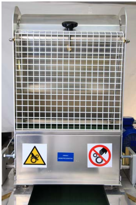
Ostona(kratka osłaniająca) pasa listwowego podajnika Widoczne pokrętko dozownika reguluje szczelinę między pasem i tylną ścianą komory, poniżej zamknięta ostona wałka dociskowego
