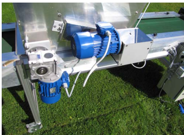
Motoreduktor wałka dociskowego po lewej oraz motoreduktor napędu urządzenia napełniającego po prawej.
