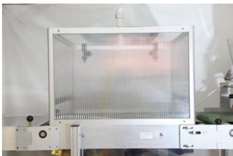
Skrzynia tunelu nawadniającego z zamontowaną lancą.
