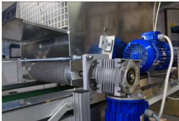
Притискний валик піддонів під пристроєм для наповнення. Вище валика - рухомий екран притискного валика.
