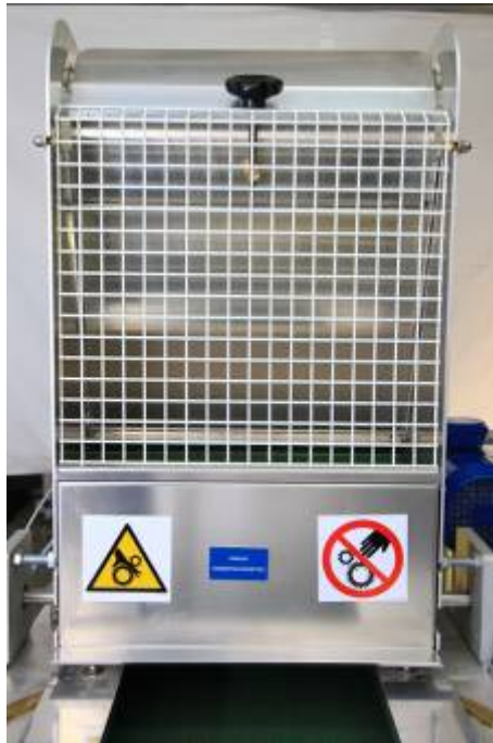
Кришка (решітка) планкової стрічки подавача Регулятор дозатора регулює щілину між стрічкою і задньою стіною камери, нижче закрита кришка притискного валика
