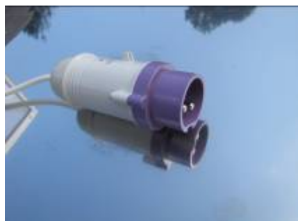
Штепсель електропроводки для поєднання електроклапану з панеллю управління.
