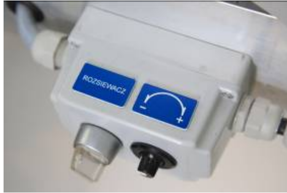
Управляюча касета розсіювача перліту
