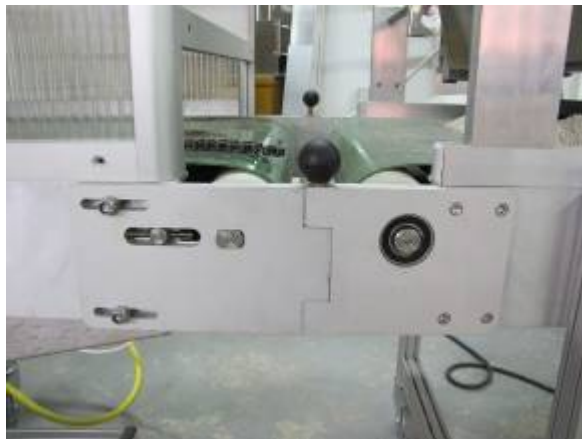
Монтажна плитка з натягом і монтажна плитка пасивного приводу. Видні ручки болта замка.
