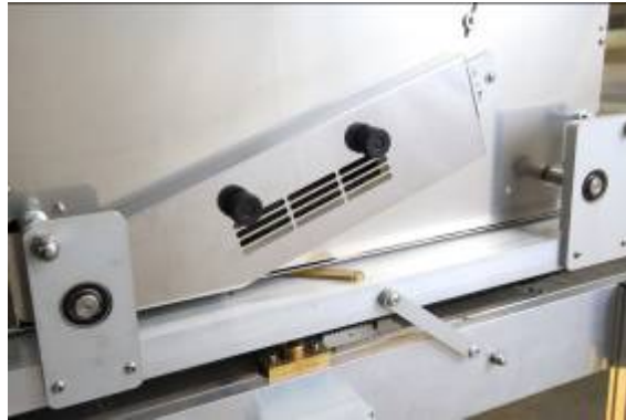
Кришка планки для очищення стрічки подавача.
