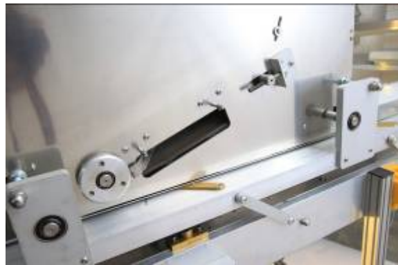
Пристрій для наповнення із знятою кришкою.
