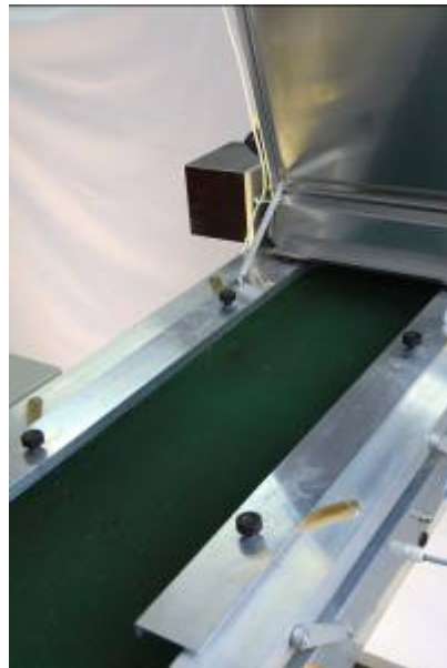
Притискний регулятор кутів профілів столу.
