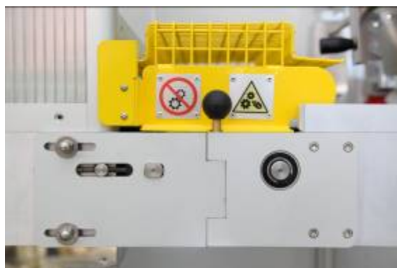
Монтажна плитка з натягом і монтажна плитка приводного валика модуля
