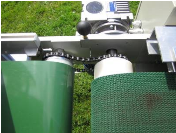
Ланцюг, який переносить привід з приводного валіка TG на валік, що приймає привід наступного транспортера
