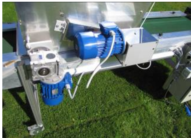
Моторедуктор притискного валика з лівого боку та моторедуктор і захист коробки зубчатої передачі пристрою для наповнення з правого боку.
