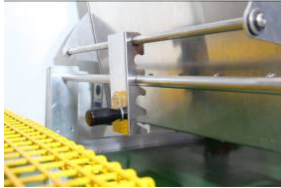
Ступінчата опора камери розсіювача перліту
