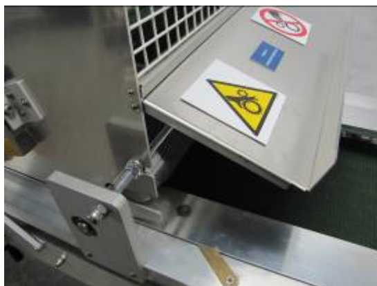
Відкинута кришка притискного валика
