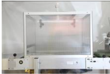
Коробка тунелю для наводнення з встановленою кінцівкою
