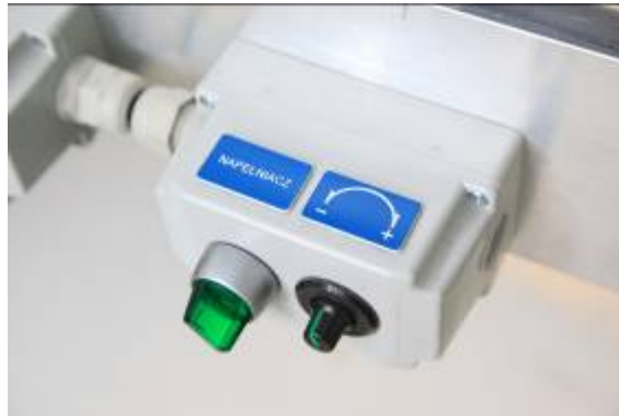
Касета управління пристрою для наповнення
