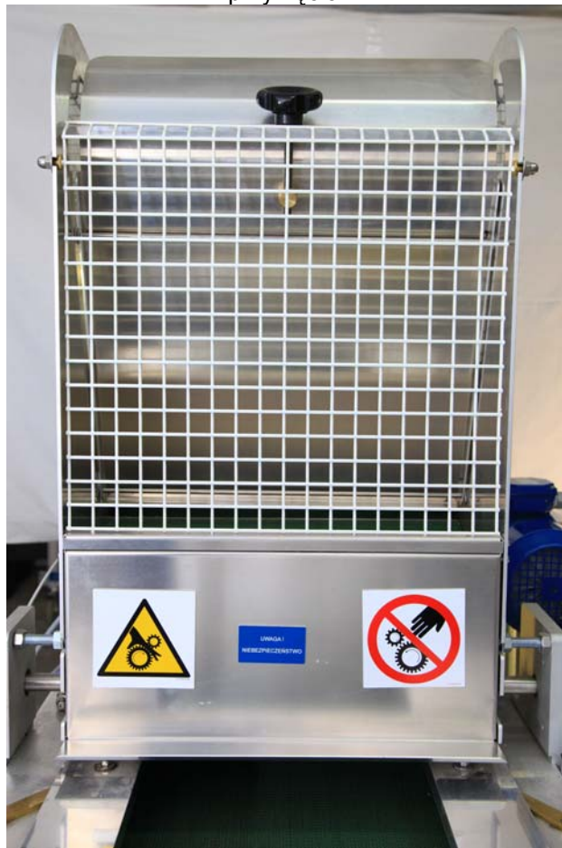
Ośłona(kratka osłaniająca) pasa listwowego podajnika Widoczne pokrętko dozownika reguluje szczelinę między pasem i tylną ścianą komory, poniżej zamknięta osłona wałka dociskowego
