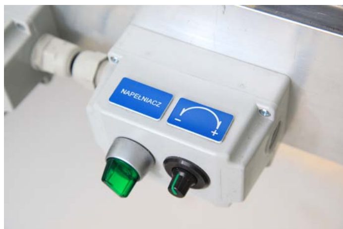
Kaseta sterownicza urządzenia napełniającego
