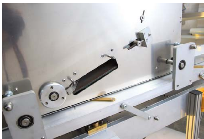
Urządzenie napelniające ze zdjętą osłoną
