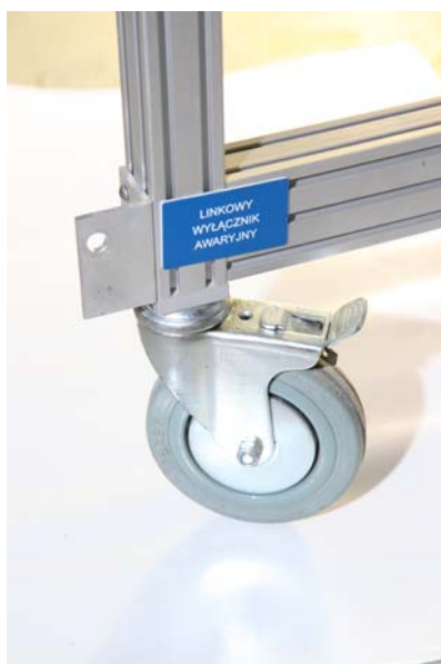
Noga transportera z kołem jezdnyim wyposażonym w hamulec zaciskowy
