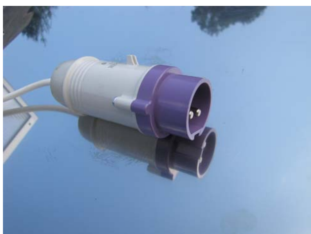
Wtyczka instalacji łączącej elektrozawór z panelem sterującym.
