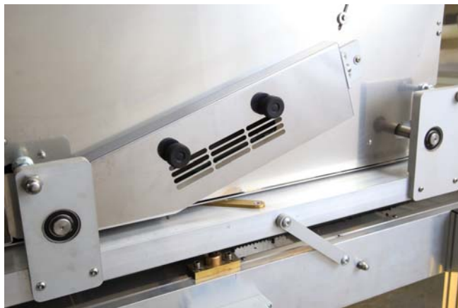
Oslona listwy czyszczącej pas podajnika
