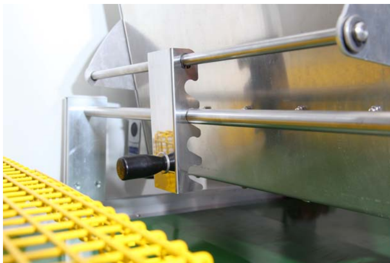
Stopniowana podpora komory rozsiewacza perlitu
