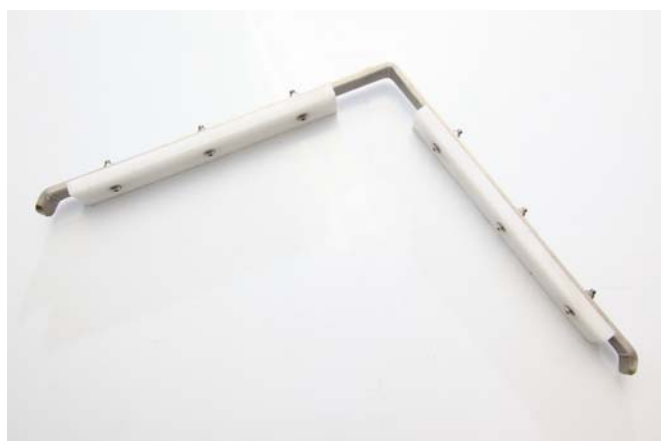
Zgarniak czyszczący pas urządzenia napelniającego
