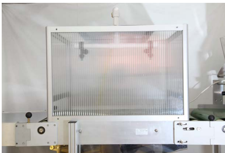
Skrzynia tunelu nawadniającego z zamontowaną lancą.
