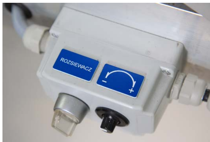
Kaseta sterownicza rozsiewacza perlitu
