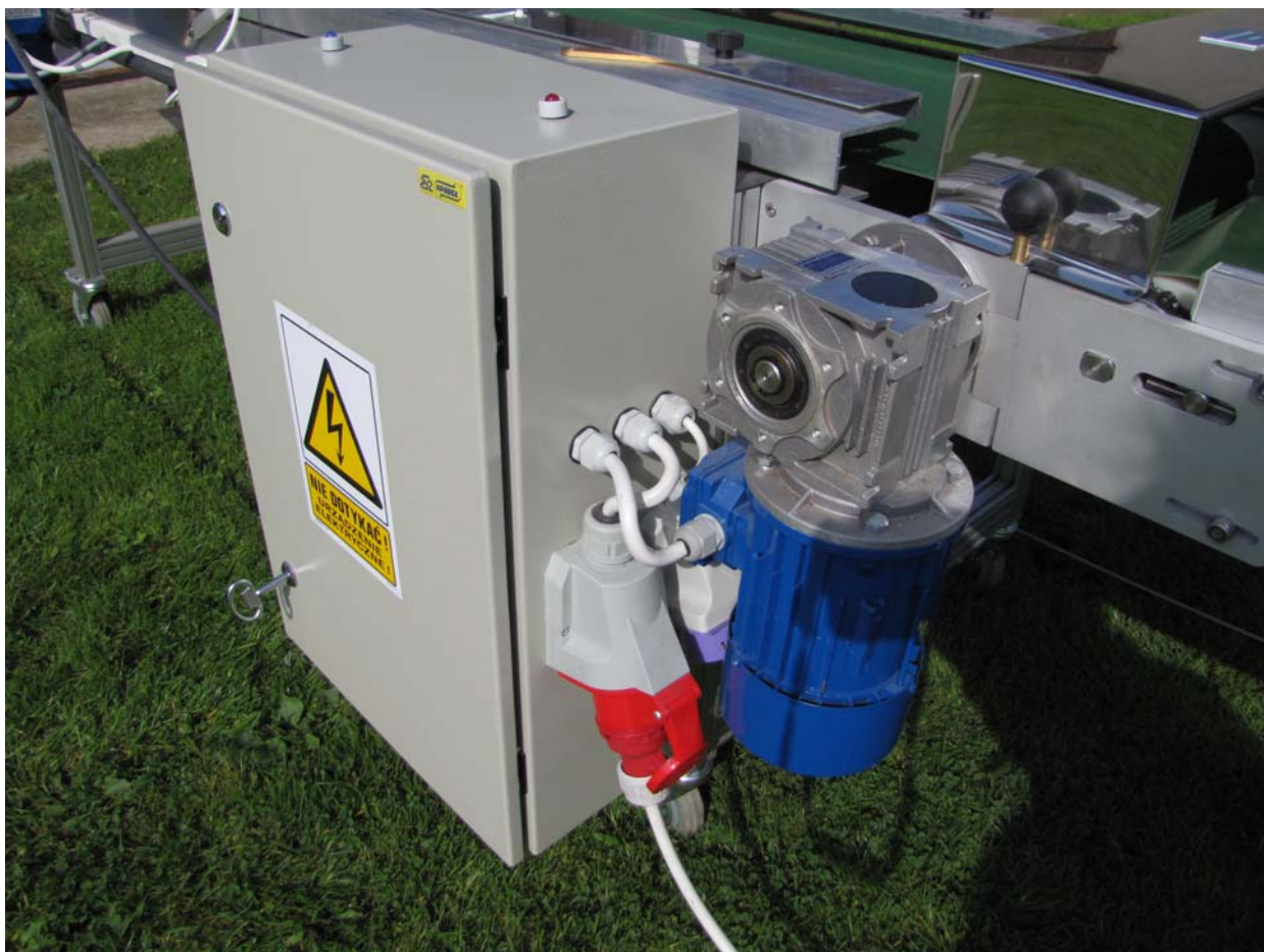
Skrzynia sterownicza z boku widoczne gniazda do podłączenia urządzeń, z góry lampki sygnalizacyjne.
