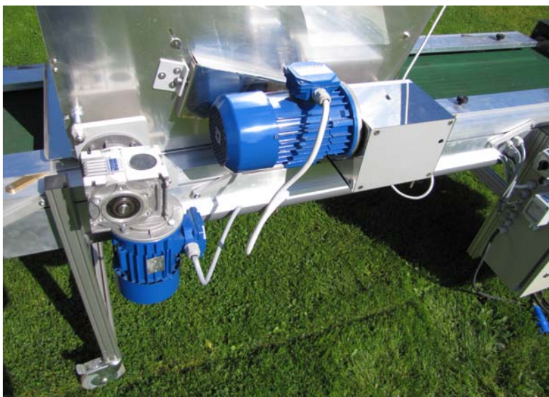
Motoreduktor wałka dociskowego po lewej oraz motoreduktor i osłona skrzynki przekładni zębatej napędu urządzenia napelniającego po prawej.
