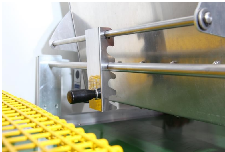
Ступінчаста опора камери розсіювача перліту
