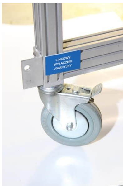
Нiжка транспортера з ходовим колесом, оснащеним притискним гальмом
