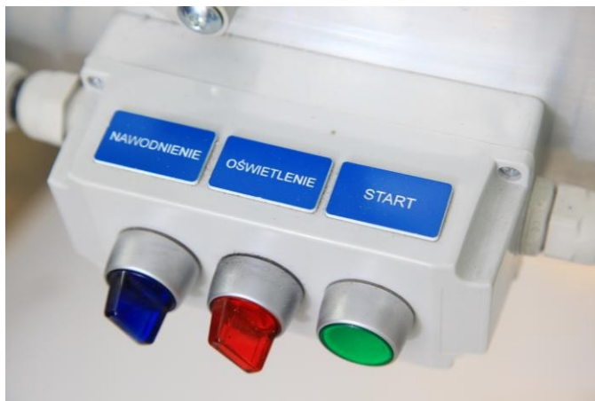
Касета управління кнопки пуску, освітлення та зрошення Кнопка ПУСК
