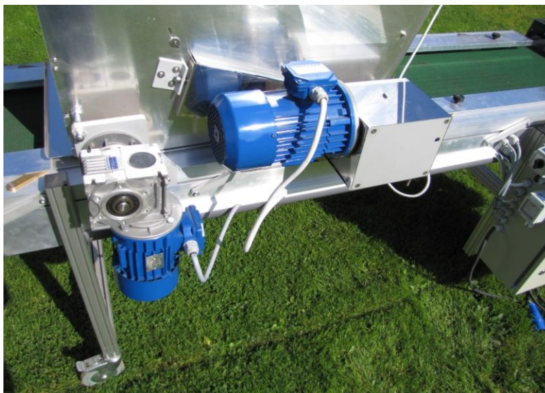
Моторедуктор притисного валика з лівого боку та моторедуктор і захист коробки зубчатої передачі пристрою для наповнення з правого боку.
