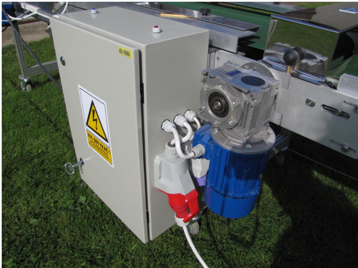
Шафа управління, збоку видні розетки для підключення пристроїв, згори сигналізаційні лампи.
